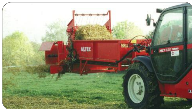
DT120 latérale inversée, paillage à droite et à gauche+ rouleau de chargement motorisé
