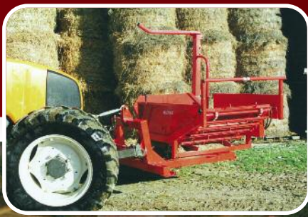
Montage sur relevage avant
