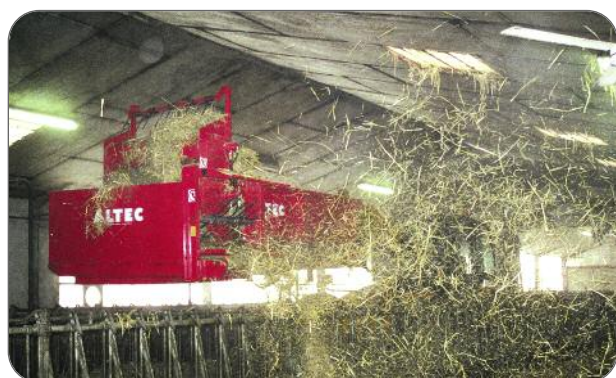
DT120 latérale paillage au dessus des cornadis sur télescopique.
