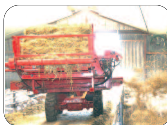
DT120 latérale inversée, paillage à droite et à gauche+ rouleau de chargement motorisé
