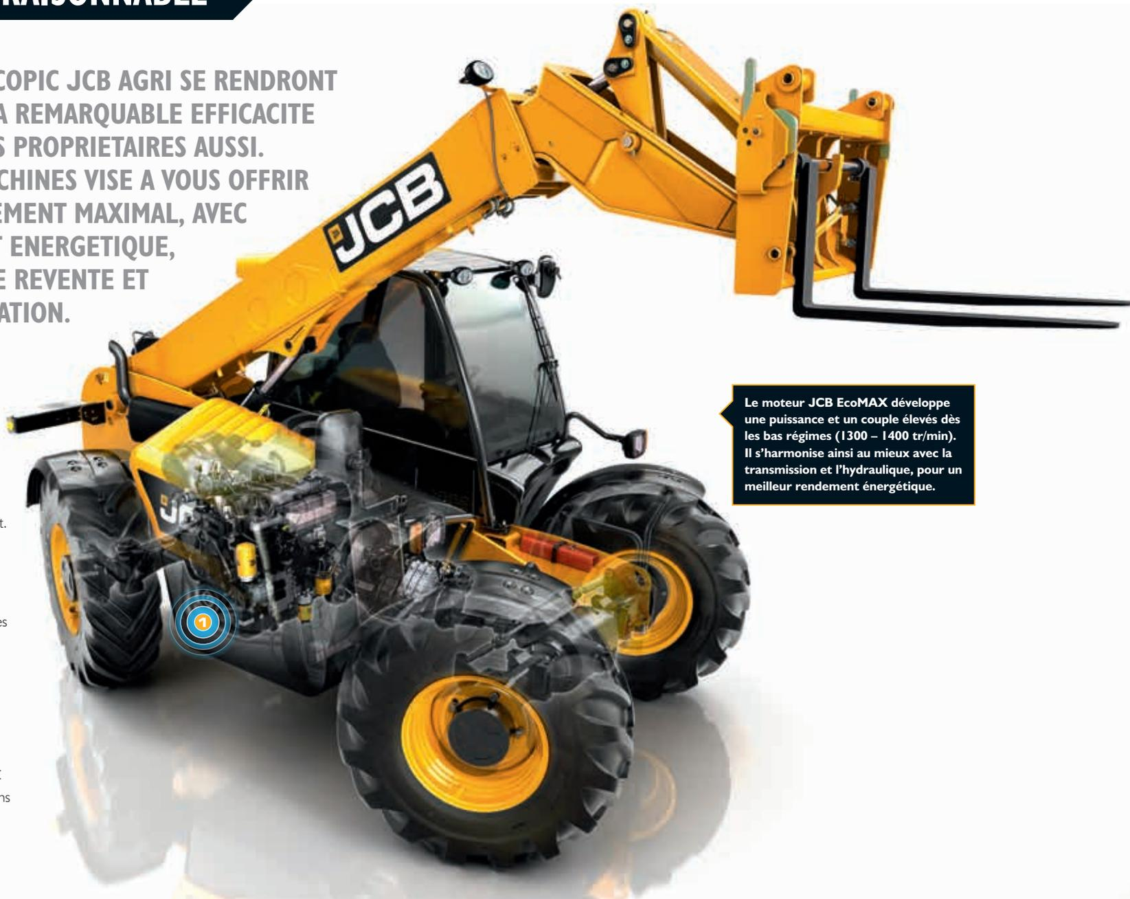
Le moteur JCB EcoMAX développe une puissance et un couple élevés dès les bas régimes (1300 – 1400 tr/min). Il s'harmonise ainsi au mieux avec la transmission et l'hydraulique, pour un meilleur rendement énergétique.
