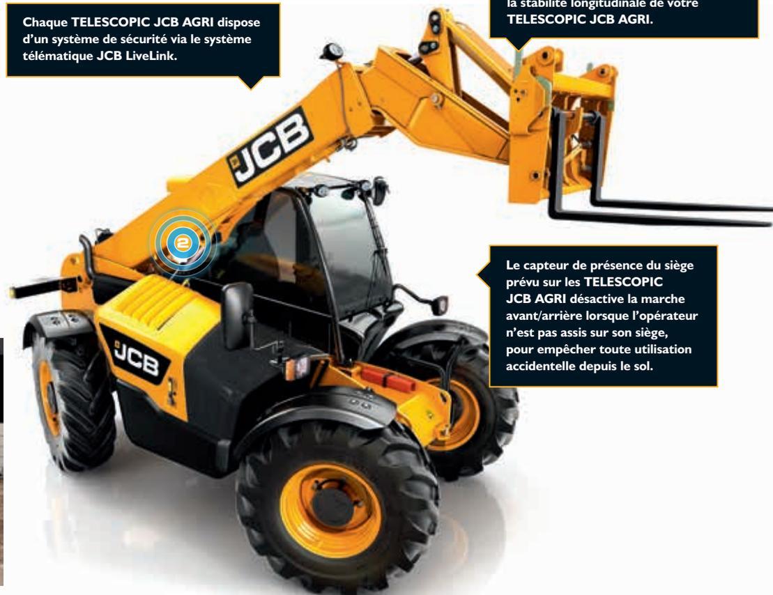
Le système JCB ALC (Adaptive Load Control) contrôle automatiquement les opérations hydrauliques pour maintenir la stabilité longitudinale de votre TELESCOPIC JCB AGRI.
