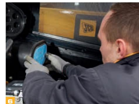
Pour permettre des inspections simples et rapides sur les trois côtés du moteur, les TELESOPIC JCB AGRI sont dotés d'un compartiment grand et large auquel on accède par un large capot à vérins à gaz.
