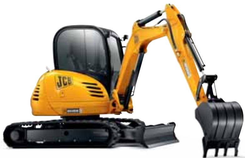
Cette machine met tout autant l'accent sur la sécurité que sur le confort, c'est pourquoi la visibilité panoramique est excellente. La chenille gauche est entièrement visible et à droite, le capot moteur incliné dégage la vue sur la chenille. Les canalisations passent sur le haut de la flèche plutôt que sur le côté, là encore, pour améliorer la visibilité, tandis que le large pare-brise avant permet de surveiller la charge jusqu'en haut.
