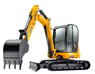
Au coeur de la JCB 8065, se trouve le nouveau moteur Isuzu Tier III de 40,5 kW (54,3 cv). Grâce à sa puissance combinée au déport arrière réduit (RTS), la JCB 8065 se montre particulièrement productive dès qu'il s'agit de travailler dans des espaces exigus. Dotée en outre, d'un nouveau balancier renforcé de 1900 mm, elle se présente comme une midi pelle extrêmement performante, destinée aux applications les plus exigeantes.
